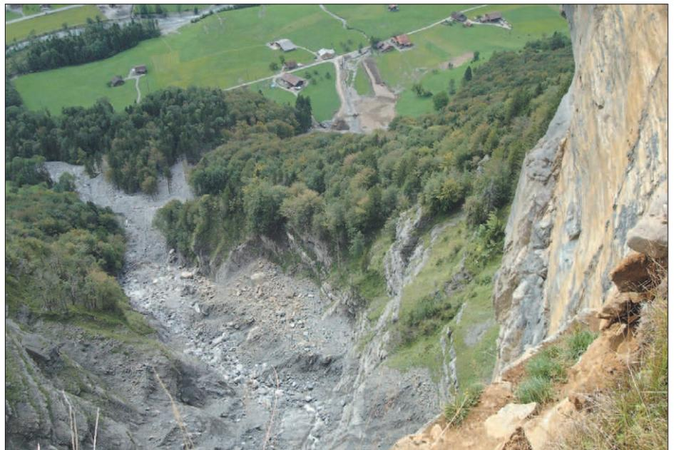
Blick von oben in den Trichter. Deutlich zu erkennen der verbliebene Geschiebekegel im Kessel, die Ausbruchsstelle und die Renaturierung im Tristel.
