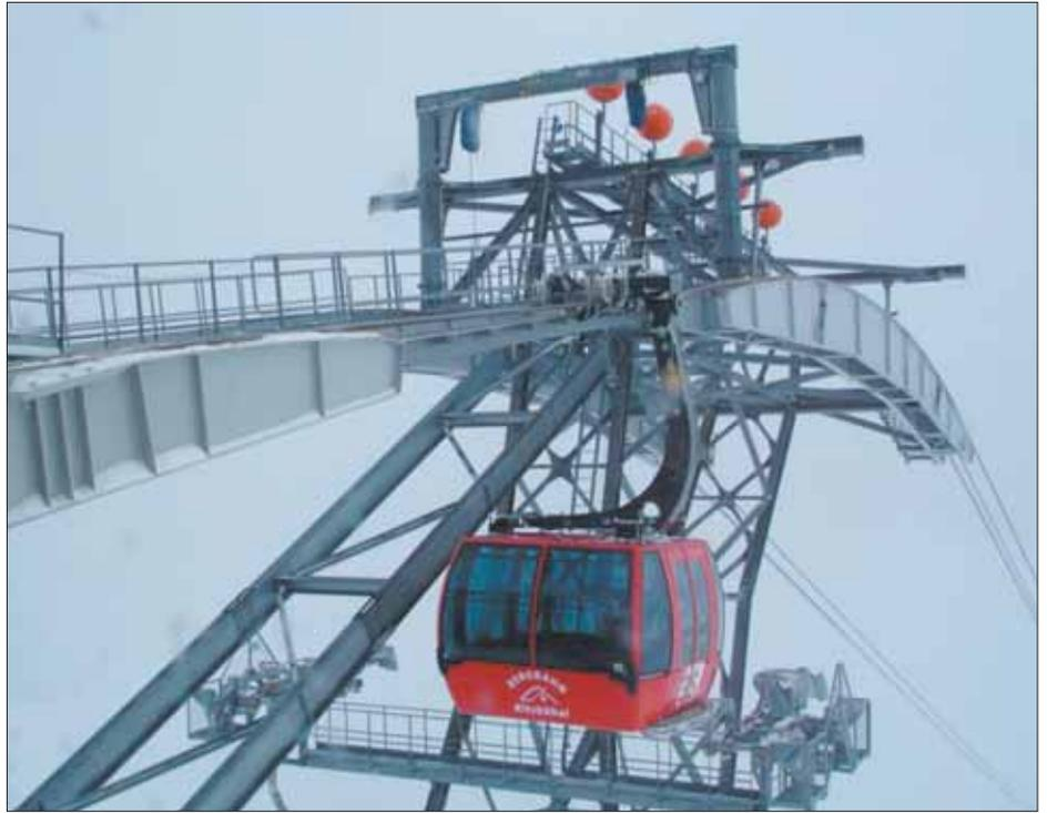
Vorbild für die neue Gondelbahn auf den Stoos ist die 3S Verbindungsbahn von der Wurzhöhe (1739) auf den Pengelstein (1938m), die in Kitzbühl über ein Tal führt.
